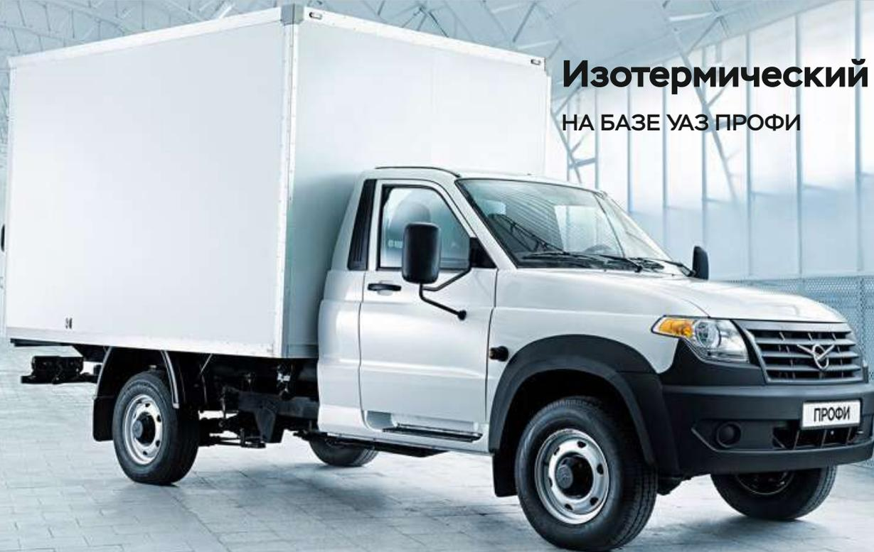
Изотермический фургон низкой / высокой степени изотермичности - для перевозки грузов и продовольственных товаров, требующих соблюдения температурного режима от +12 до 0°C / от +12 до -20°C
