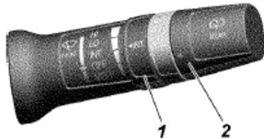
IV – activado el modo constante (alta velocidad) de trabajo del limpiaparabrisas del parabrisas. Posición fija.
