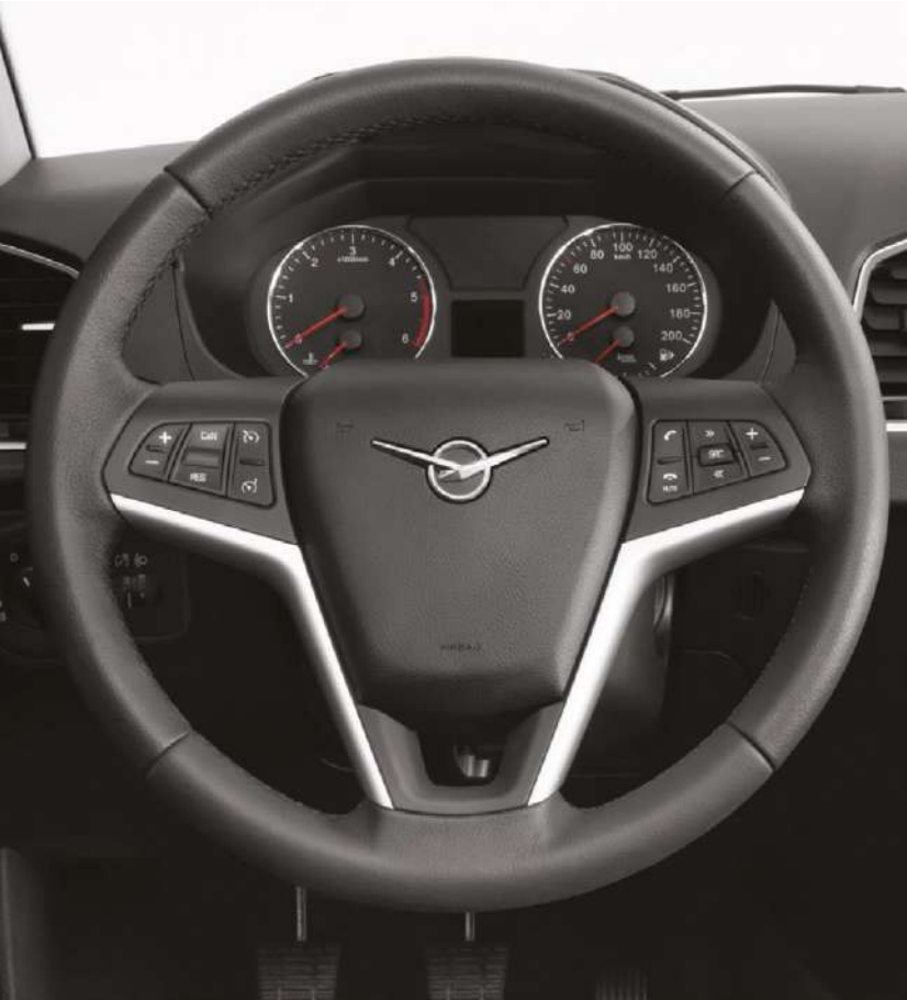
Volante multifuncional con control de cruceo y limitador de velocidad, sistema multimedia y de manos libres
