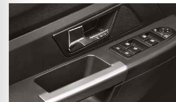
Control de elevallas eléctrico y retrovisores exteriores en la puerta del conductor
