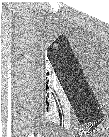
Рис. 9.46. Люк доступа к задним фонарям: 1 -фиксатор держателя крышки; 2 -держатель крышки; 3 -крышка
