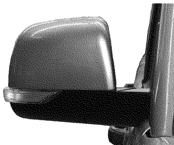
Рис. 9.45. Зеркало заднего вида с боковым указателем поворота
