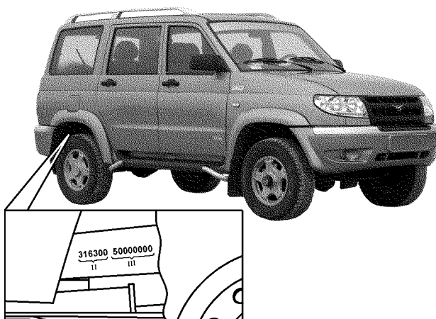
Рис. 1.3. Расположение идентификационного номера шасси
