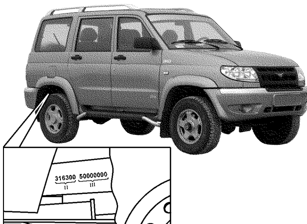
Рис. 1.3. Расположение идентификационного номера шасси
