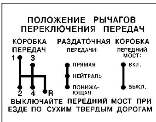
Рис. 3.2. Схема положений рычага коробки передач и рычагов раздаточной коробки
