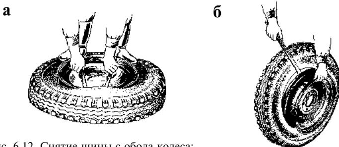
Рис. 6.12. Снятие шины с обода колеса:
