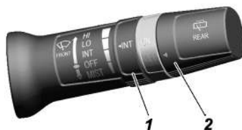
Рис.3.11. Правый рычаг подрулевого переключателя: 1 -поворотный регулятор длительности пауз; 2 -поворотный переключатель заднего омывателя
