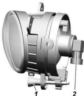
Рис. 9.35. Противотуманная фара: 1 -регулирующий винт; 2 -колодка жгута проводов
