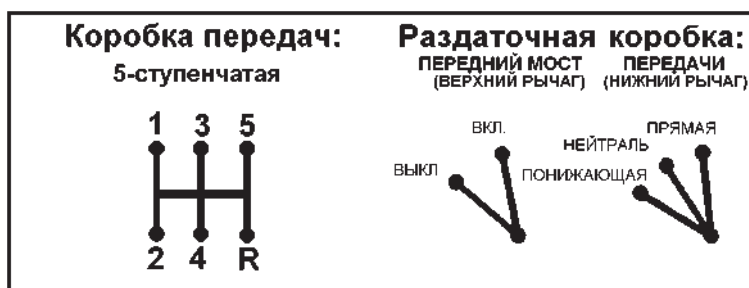
Рис. 3.2. Схема положений рычагов коробки передач и рычагов раздаточной коробки
