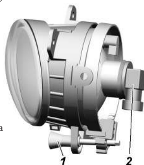
Рис. 9.40. Противотуманная фара: 1 -регулирующий винт; 2 -колодка жгута проводов
