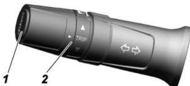
Рис. 3.6. Органы управления маршрутным компьютером на левом рычаге подрулевого переключателя: 1 -кнопка; 2 -кольцо переключателя «TRIP»
