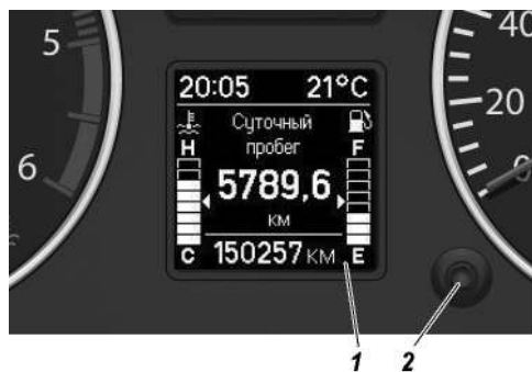
Рис. 3.5. Управление маршрутным компьютером на комбинации приборов: 1 -жидкокристаллический дисплей; 2 -переключатель маршрутного компьютера
