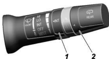
Рис.3.11. Правый рычаг подрулевого переключателя: 1 -поворотный регулятор длительности пауз; 2 -поворотный переключатель заднего омывателя (не используется)
