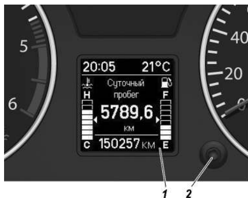
Рис. 3.7. Управление маршрутным компьютером на комбинации приборов 1 -жидкокристаллический дисплей; 2 -переключатель маршрутного компьютера
