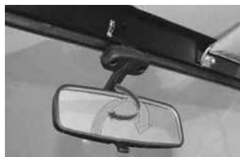
Рис. 3.8. Регулировка внутреннего зеркала
