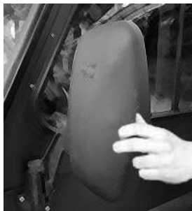
Рис. 3.9. Регулировка наружного зеркала
