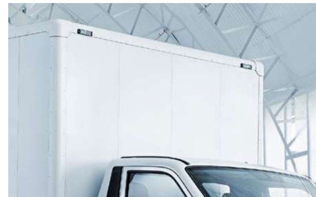
Наружное освещение (вид спереди)
