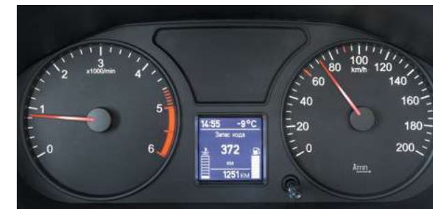
Бортовой компьютер с управлением на левом подрулевом переключателе
