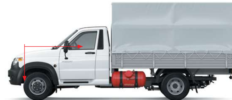
Кapotная компоновка обеспечивает большую безопасность водителя при лобовом столкновении
