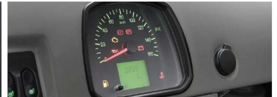
Tablero de instrumentos y toma de 12v
