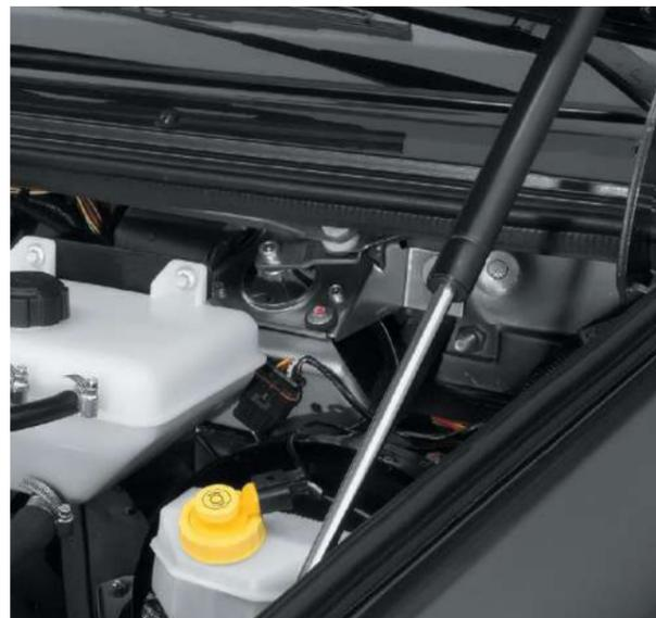
Пневмопружина облегчает подъем капота и удерживает его в поднятом состоянии. Чтобы заглянуть под капот, не придется прикладывать значительных усилий.
