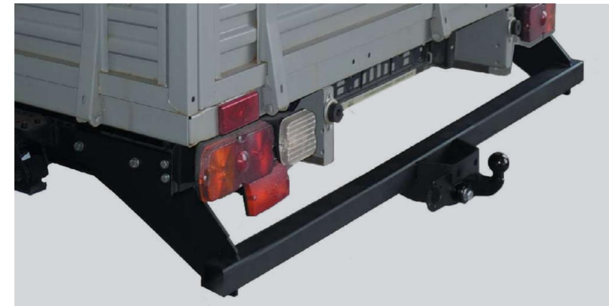
Тягово-цепное устройство предназначено для шарнирной сцепки автомобиля с буксируемым прицепом. При его разработке для безопасной перевозки учтены особенности конструкции автомобиля.
