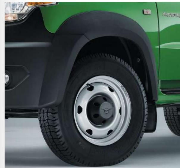
Пластиковые подкрылки для защиты колесных арок от коррозии. Какими бы тяжелыми ни были условия эксплуатации грузовика, арки останутся в полном порядке.
