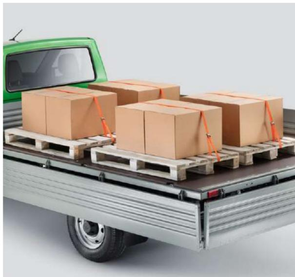
Комплект стяжных ремней для фиксации груза позволяет надёжно зафиксировать груз и предотвратить его перемещение по грузовой платформе.
