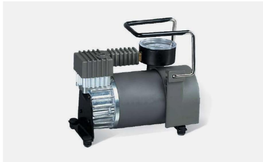
Компрессор с насосом поршневого типа, не требующий смазки, воздушные клапаны из прочной, нержавеющей стали и точный двухшкальный манометр. Специальный спускной клапан DEFLATOR для регулировки давления. Производительность компрессора: 40 литров в минуту.
