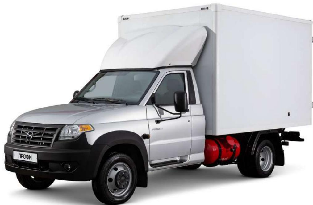
Спойлер для снижения лобового сопротивления позволяет снизить расход топлива до 20%. Изготовлен из 2-х слойного композитного материала. Крепится на специально разработанное антикоррозионное крепление. Все металлические детали крепления обработаны 2-х слойным порошковым покрытием.
