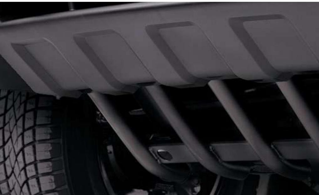
Защита рулевых тяг сохранит целыми низко расположенные агрегаты при наезде на препятствие. Защита изготовлена из стальных труб диаметром 42 мм. Конструкция обладает достаточной жесткостью, чтобы рулевые тяги не пострадали.
