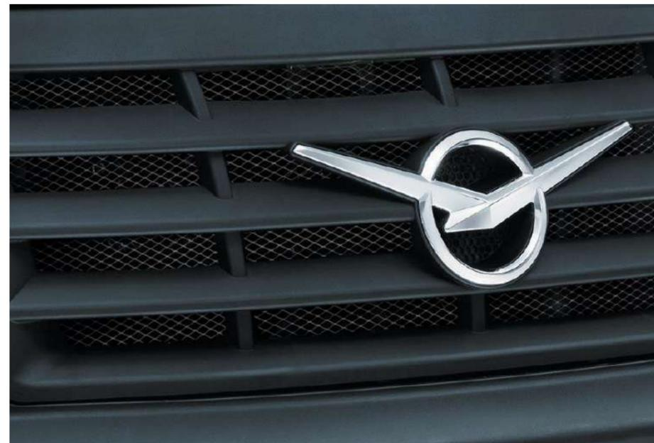
Сетка обеспечивает защиту радиатора от повреждений и засорения посторонними частицами, тем самым предотвращает перегрев двигателя. Размер ячеек сетки подобран специальным образом, чтобы сетка выполняла не только функцию надежной защиты, но и при этом не мешала прохождению воздушных потоков.
