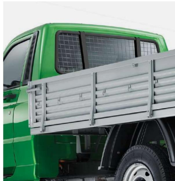
Решетка защищает стекло при транспортировке груза и позволяет с дополнительным уровнем безопасности перевозить длинномерные грузы. При этом обзор с водительского места не страдает.
