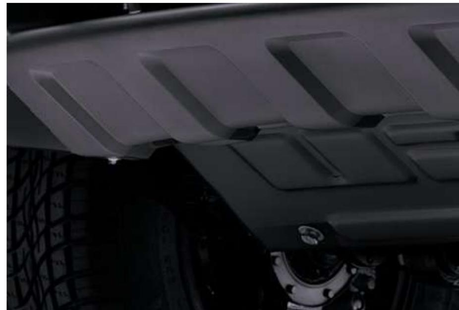
Рулевые тяги останутся в целости и сохранности при наезде на препятствие. Защита изготовлена из стального листа толщиной 3 мм. Конструкцию отличает высокая ударпрочность.
