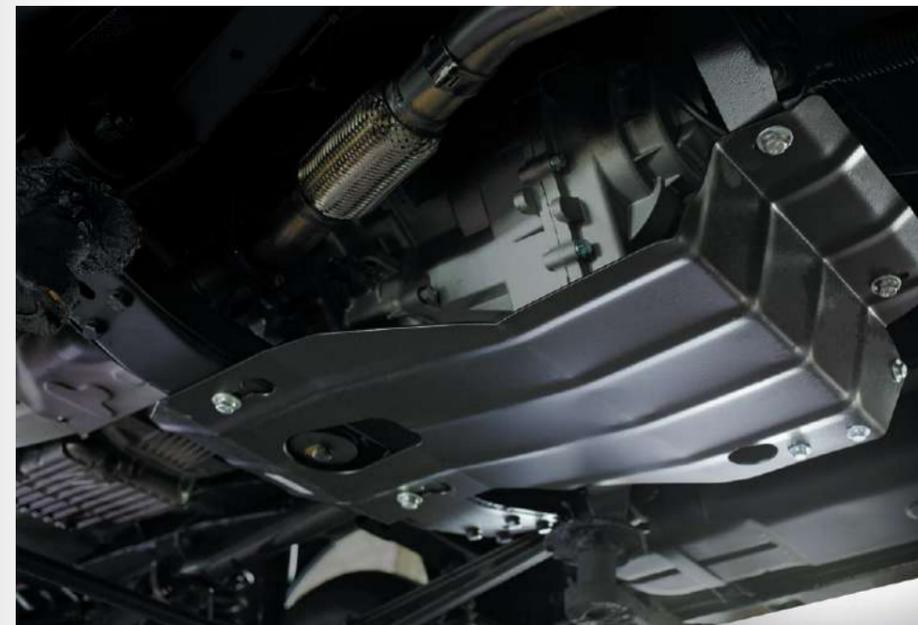
Стальной лист защищает важнейший узел автомобиля – КПП. Защита отличается высокой прочностью, коррозионной устойчивостью и надежными креплениями.
