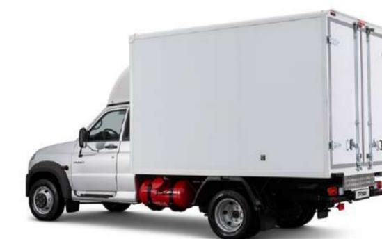
Модификация, получившая официальное название «Полуторка», приходит на смену прежнему моноприводному варианту «Профи» в модельной линейке бренда. Десятки конструктивных новшеств позволили повысить запас прочности, уровень безопасности, степень комфорта и улучшить ходовые свойства ульяновского LCV. Схема с односкатной ошиновкой колес заднего моста, как наиболее эффективная для автомобилей с полным приводом, сохранится для версий 4x4.
