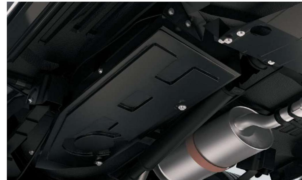
Надежный стальной лист с высокой ударпрочностью защищает топливный бак от повреждений. Особую стойкость обеспечивают ребра по периметру защиты.
