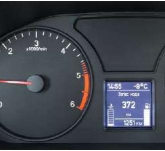
Бортовой компьютер с управлением на левом подрулевом переключателе
