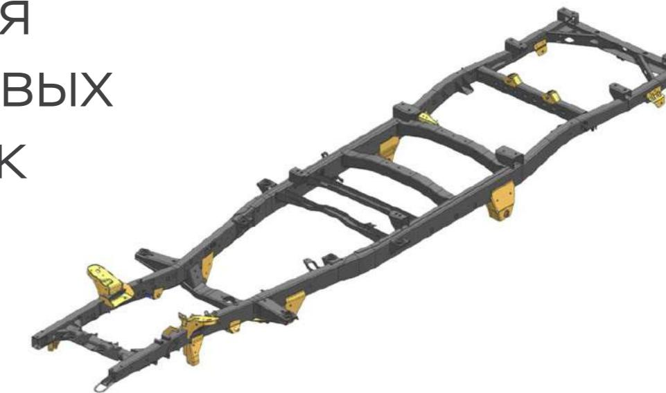
Благодаря прочной рамной конструкции УАЗ Профи прекрасно адаптирован под российские условия эксплуатации и предусматривает возможность установки широкой гаммы надстроек. Модель оснащается колесными дисками с шестью точками крепления и специальными усиленными шинами для коммерческого транспорта. Каждая покрышка выдерживает самые высокие нагрузки благодаря увеличенному профилю и повышенной норме слойности для грузовых автомобилей.
